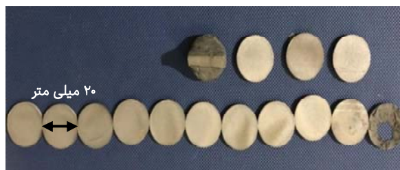
شکل ۳) قرص های تهیه شده از جنس سوپرآلیاژ پایه نیکل
