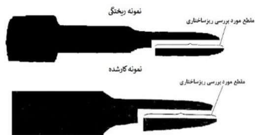
شکل ۳) نحوه برش کاری نمونه پس از آزمایش کشش جهت بررسی ریزساختار
