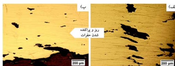
شکل ۱۰ (الف) مقایسه توزیع حفرات نمونه های فولاد W360 پس از آزمایش کشش گرم در نرخ کرنش ۰/۱ بر ثانیه و دمای ۲۰۰ درجه سانتی گراد در شرایط (الف) ریختگی، (ب) کار شده
