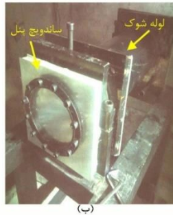
شکل ۲) الف) تصویر شماتیک و ب) دستگاه لوله شوک مورد استفاده در این تحقیق.
