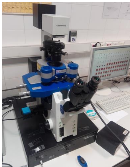
شکل ۷) میکروسکوپ نیروی اتمی 2 JPK Instruments-NanoWizard برای آزمودن تیرک در محیط آب
