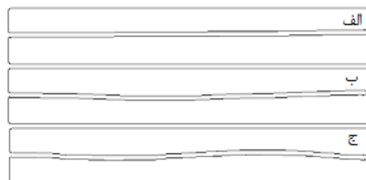
شکل ۸) اشکال مودی استخراج شده: الف. شکل مود اول ( \alpha=40 )، ب. شکل مود دوم ( \alpha=170 )، ج. شکل مود سوم ( \alpha=200 ) - (ارتعاش آزاد تیر فولادی با اتصال گیردار)
