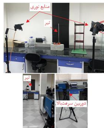
شکل ۲۱) مدل آزمایشگاهی اندازه‌گیری ویدیویی در آزمایش ارتعاش آزاد تیر آلومینیومی با اتصال گیردار
