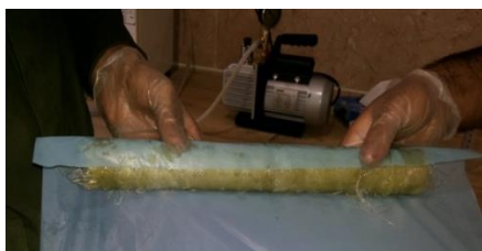
شکل ۷ پیچش لایه نایلون متخلخل به دور نمونه.
