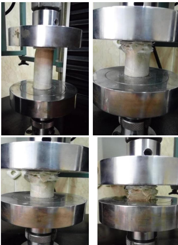
شکل ۱۱) نمونه ترکیبی آلومینیوم/کامپوزیت تحت بارگذاری فشاری شبه‌استاتیکی.
