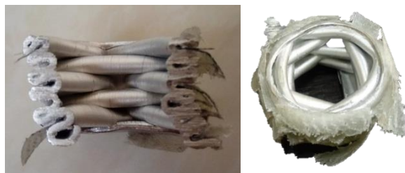
شکل ۱۵) نمونه ترکیبی آلومینیوم/کامپوزیت با درصد هم‌پوشانی ۵ درصد بعد از اعمال بارگذاری.
