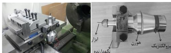
شکل ۳) ابزار کوبش فراصوتی و نگاه‌دارنده (ب) نگاه‌دارنده و اتصال ابزار کوبش فراصوتی روی دستگاه
