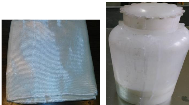
شکل ۱) پارچه از جنس شیشه E-Glass و محلول تفلون با درصد وزنی ۶۰ درصد.
