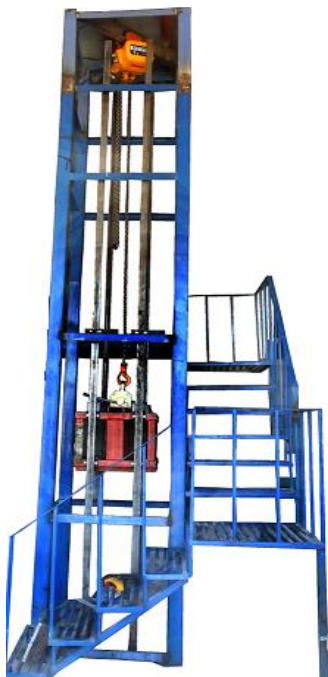
شکل ۱) سامانه سقوط وزنه با ظرفیت پایین در آزمایشگاه ضربه و انفجار در دانشگاه گیلان
