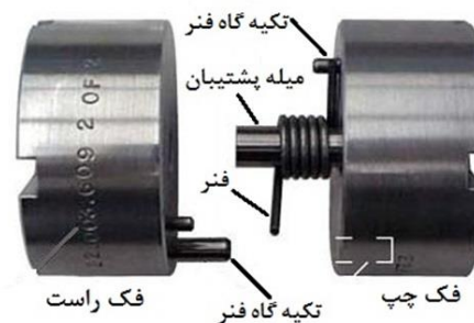
شکل ۸) شماتیک نحوه قرارگیری فنر بین دو فک
