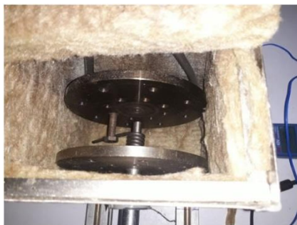
شکل ۶) نمای داخل کوره و عایق بندی آن
