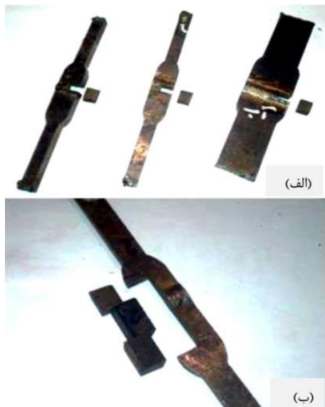
شکل ۳ الف- نمونه‌های برش کاری توسط وایرکات برای متالوگرافی ب- نمونه‌های برش کاری شده توسط وایرکات برای آزمون ریزسختی سنجی
