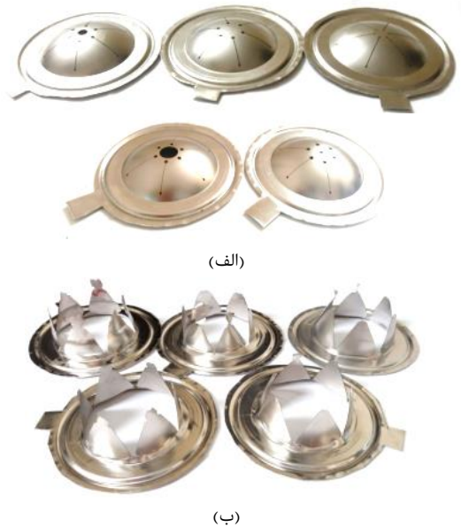
شکل ۲) الف- تعدادی از نمونه‌های آماده شده بعد از شکل‌دهی و ایجاد شیار در الگوهای متفاوت ب- تصویری از نمونه‌ها بعد از تست پارگی
