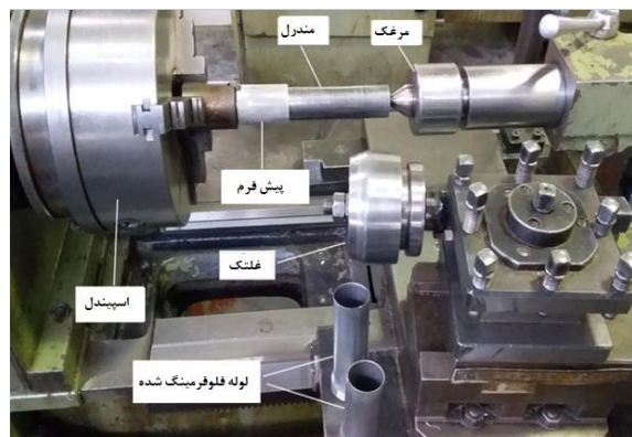
شکل ۱) تجهیزات فرایند فلوفرمینگ مورد استفاده در پژوهش حاضر
