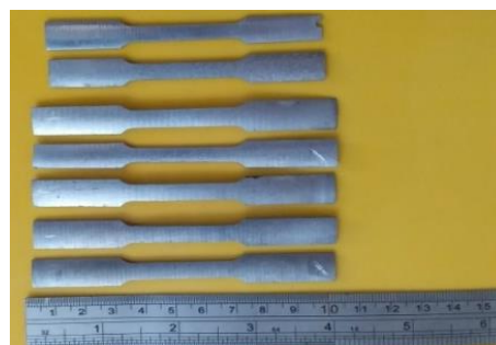
شکل ۹) برخی نمونه‌های آزمایش کشش برش داده‌شده از لوله فلوفرم شده
