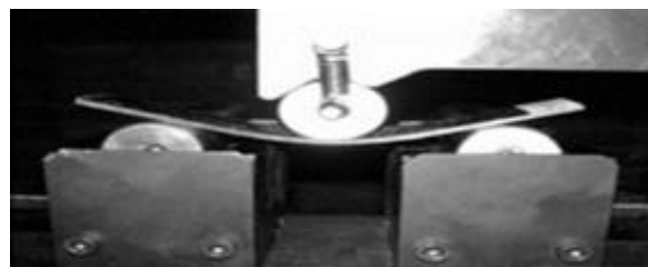
شکل ۶) نمونه کامپوزیتی ساخته شده تحت آزمون خمشی
