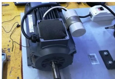
شکل ۳) میکروفن مورد استفاده جهت داده‌برداری و چگونگی نصب آن
