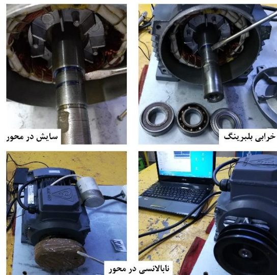
شکل ۴ خرابی‌های الکتروموتور
