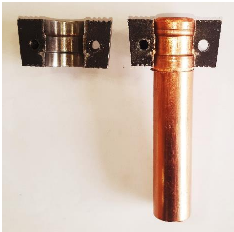
شکل ۳) اجزای قالب فرآیند اکستروژن شدن فشاری تناوبی هیدرواستاتیک شده
