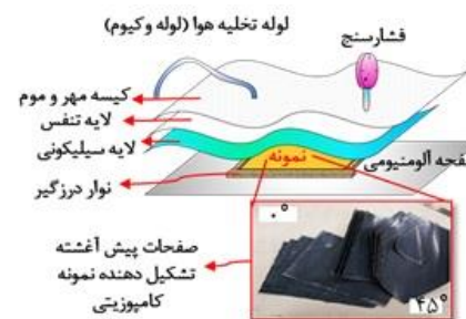
شکل ۳) شماتیک از آماده سازی نمونه‌ها قبل از اتوکلاو و برش صفحات پیش آغشته جهت لایه چینی
