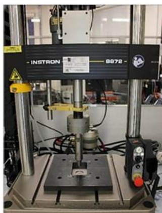
شکل ۵) نما و شماتیک از تجهیزات آزمایش نفوذ شبه استاتیک و نحوه قرارگیری نمونه و حسگرهای نشر آوایی
