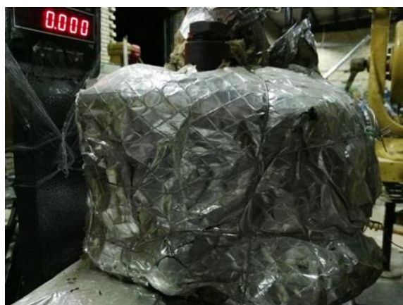
شکل ۳) مخزن بخار گازوئیل بر روی ترازو
