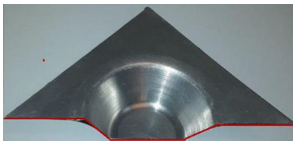
شکل (۵) مسیر اندازه‌گیری ضخامت در نمونه برش خورده در حالت AS
