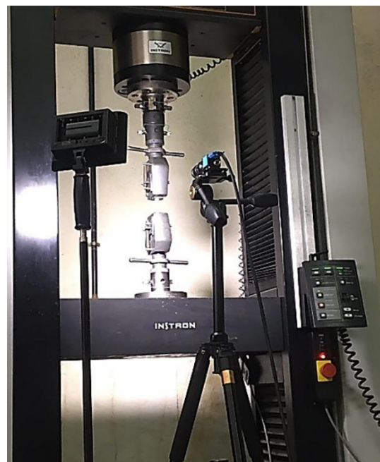
شکل ۴) آزمون تست کشش
