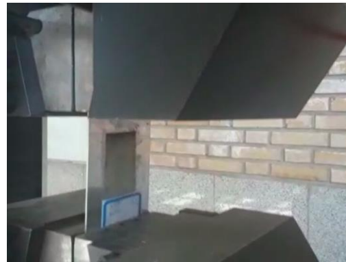
شکل ۳) نحوه قرارگیری نمونه آزمون کشش در فیکسچر دستگاه آزمون کشش
