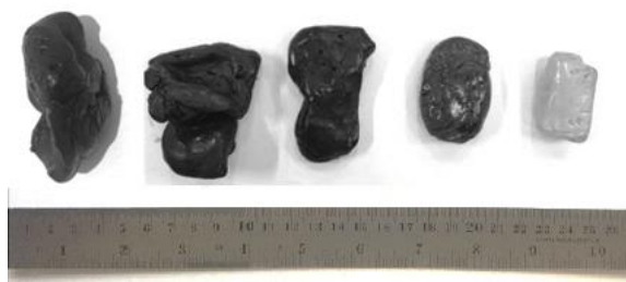
شکل ۲) تصویر نمونه‌های نانوکامپوزیت ساخته شده به روش ذوبی حالت جامد
