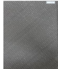
شکل ۴) نمونه صفحه کربن / اپوکسی ساخته شده به روش تزریق رزین در خلا
