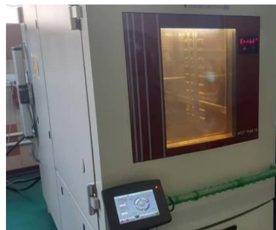
شکل ۵) آون جهت اعمال چرخه حرارتی به نمونه‌ها
