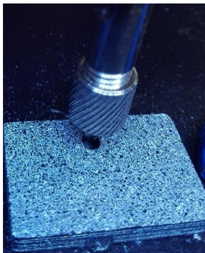
شکل ۶) عملیات سوراخکاری روی نمونه ی چاپ شده
