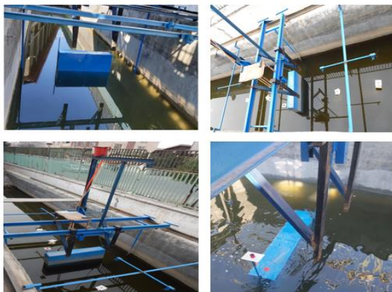
شکل ۲) نمایشی از مبدل انرژی موج صفحه‌ای ساخته شده در آزمایشگاه با مقیاس ۱:۸
