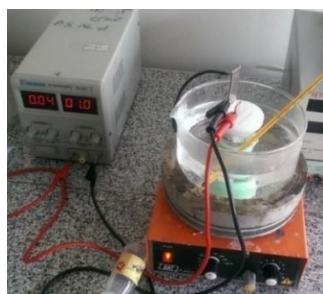
شکل ۱) چیدمان آزمایش برای فرآیند الکتروپلیتینگ
