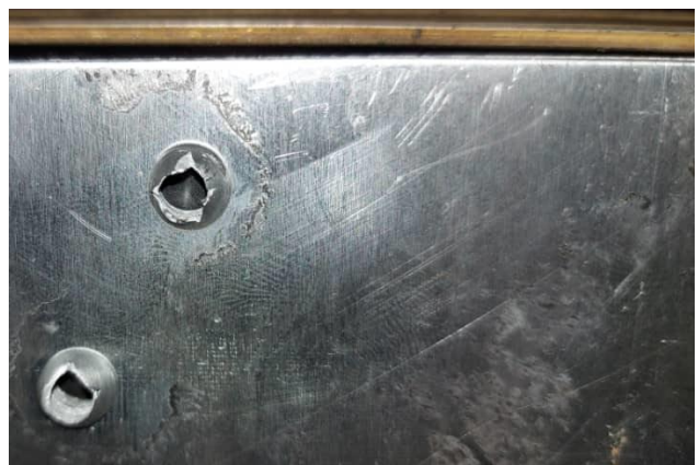
شکل ۵) نمونه ای از نتیجه سوراخکاری قطعه کار آلومینیوم
