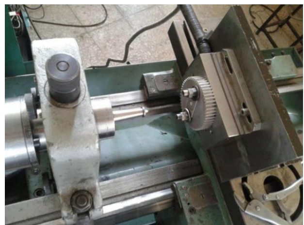
شکل ۴) مجموعه ابزار سوراخکاری ارتعاشی
