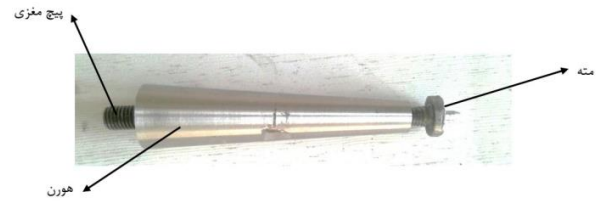
شکل ۳) اتصال هورن و مته بوسیله پیچ
