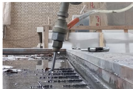
شکل ۳) تنظیم زاویه برخورد جت آب
