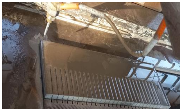
شکل ۲) قطعه کار به همراه شکاف‌های برش
