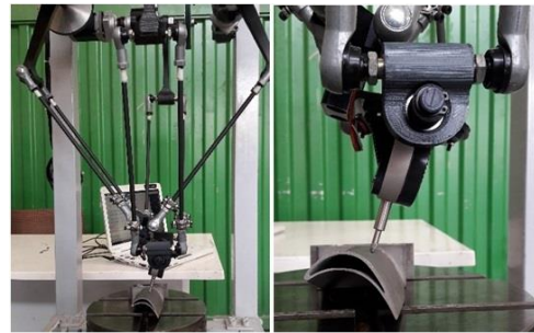
شکل ۲) تصویری از ربات C4 در کاربری به عنوان ربات CMM
