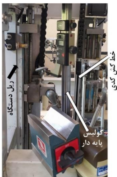
شکل ۶) اندازه‌گیری خطاهای موقعیت‌دهی محورهای حرکتی
