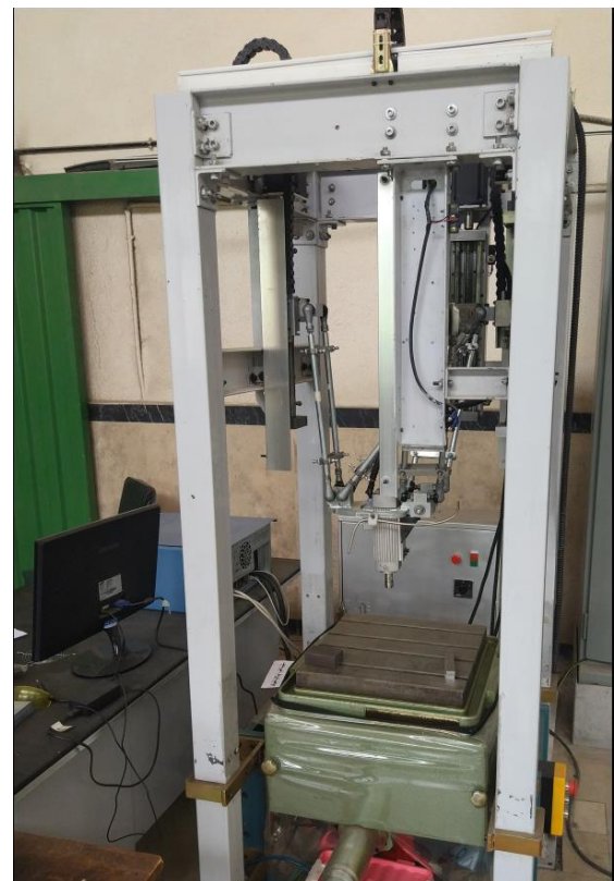
شکل ۵) ماشین فرز ۴ درجه آزادی ساخته شده
