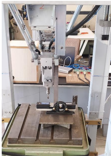
شکل ۵) تنظیمات سخت‌افزاری ربات ماشین فرز
