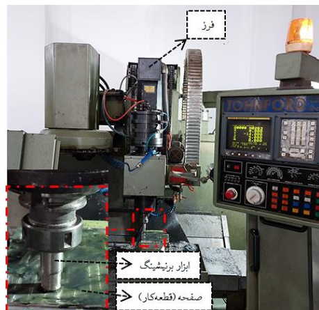
شکل ۳) تجهیزات مجموعه آزمایشگاهی فرآیند برنیشینگ صفحه
