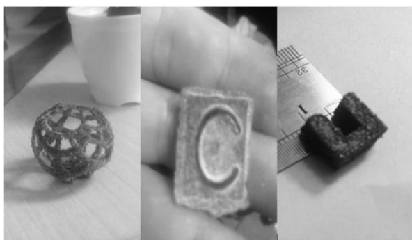
شکل (۶) قطعات ساخته شده با پودر شکر
