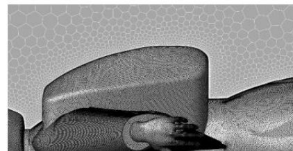
شکل ۶) الف : شبکه محاسباتی اطراف مدل ب: نمای نزدیک از شبکه بندی محاسباتی
