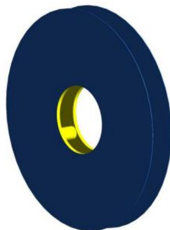
(ج) مرز آبی اتصال معمولی به همراه روتور منجمد برای حل پایا و روتور استاتور گذرا برای حل گذرا، مرز زرد دیواره
