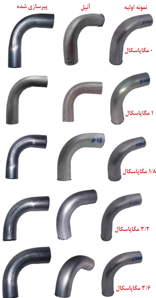
شکل ۶) لوله‌های خم شده اولیه، آنیل و پیرسازی شده در فشارهای سیال مختلف
