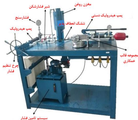
شکل (۳) دستگاه خمکاری دورانی کششی هیدرولیکی استفاده شده
