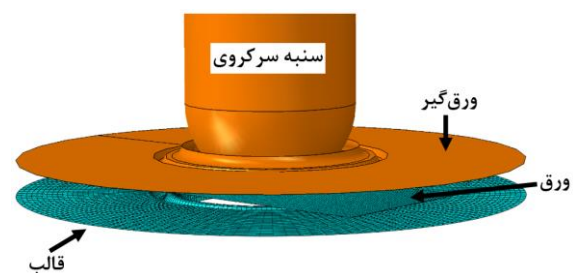
شکل ۴) اجزای قالب شکل دهی در شبیه سازی
