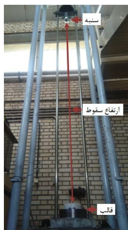
شکل ۳) چیدمان آزمایش شکل‌دهی توسط دستگاه سقوط وزنه
