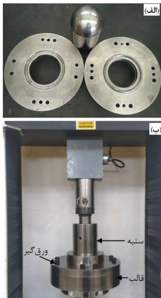
شکل ۲) (الف) اجزای قالب شامل سنبه، قالب و ورق‌گیر و (ب) قالب نصب شده روی دستگاه سنتام جهت انجام آزمایش شکل‌دهی شبه-استاتیکی
