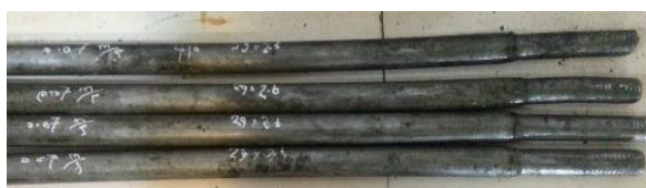
شکل ۸) لوله‌های کشش شده
