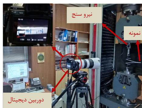
شکل ۲) نمونه تیر یک‌سرگردار دولبه در حین آزمون و تجهیزات آزمون مود اول شکست
