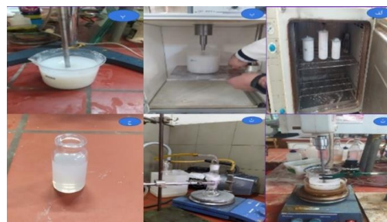
شکل ۲) نمایی آماده سازی سیال غلیظ شونده برشی: (الف) رطوبت زدایی از سیلیکای دوده شده، (ب) آلتراسونیک مواد، (پ) اختلاط مستقیم مواد با یکدیگر، (ت) همزدن و الکل زدایی، (ث) حباب زدایی، (ج) سیال غلیظ شونده برشی
