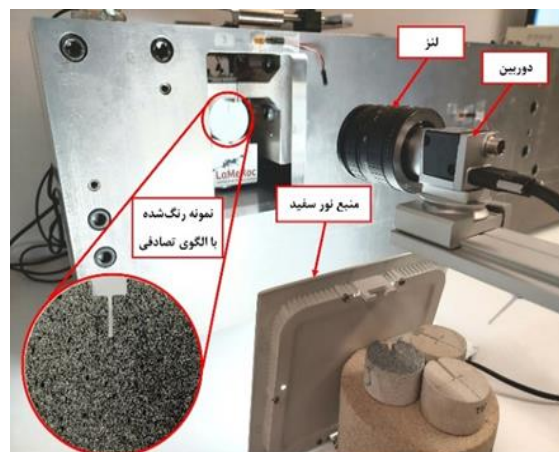
شکل ۳) تجهیزات مورد استفاده در روش برهم‌نگاری تصاویر دیجیتالی.
