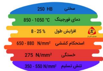
شکل ۱۱) مشخصات مکانیکی فولاد SPK1.2080
