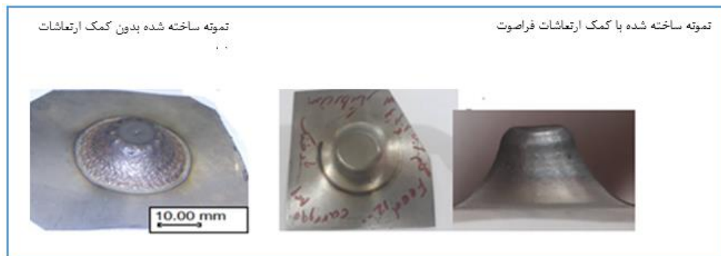
شکل ۱۰) مقایسه اختلاف ظاهری قطعات ساخته شده به کمک ارتعاشات فراصوت و تنظیم پارامترهای بهینه (تنظیم گام عمودی روی ۰/۱mm، سرعت پیشروی حدود ۹۰۰ mm/min و میزان شدت جریان ۲۲۰A) با قطعه ساخته شده بدون کمک ارتعاشات فراصوت و تنظیم همان پارامترها
