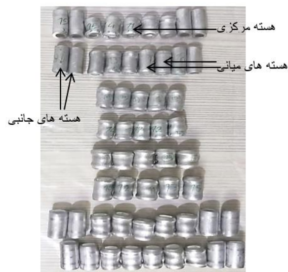
شکل ۸) تغییر شکل هسته‌های سازه پس از بارگذاری
