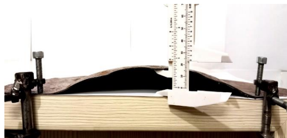
شکل ۶) بیشینه جابجایی مرکز ورق فوقانی تست (۲۲)
