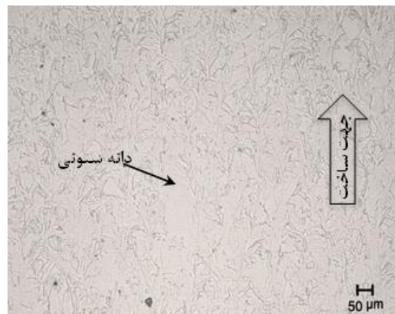
شکل ۹) تصویر میکروسکوپ نوری فلز پایه اینکونل ۷۱۸ ساخته شده به روش ذوب لیزر انتخابی
