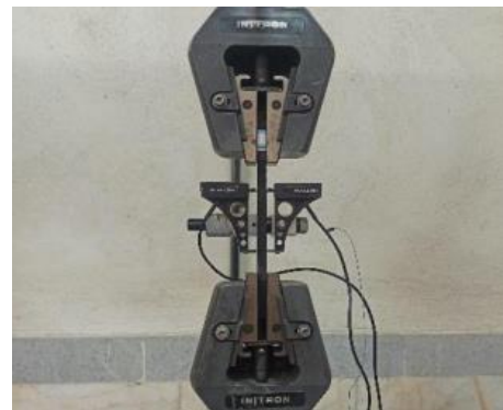
شکل (۳) دستگاه تست کشش نمونه‌های استاندارد
