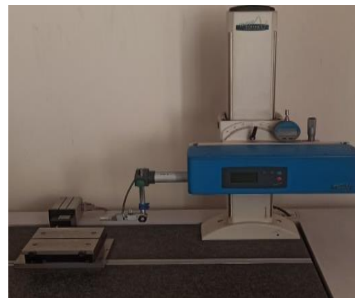
شکل ۳) دستگاه زبری سنج (Hommlewerke T8000 ساخت آلمان)
