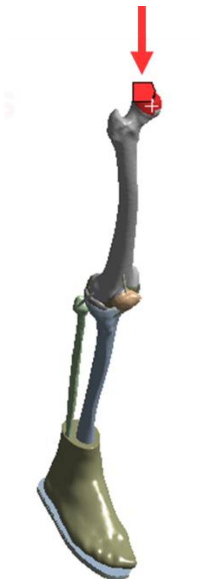
شکل ۵) نمایی از نحوه بارگذاری در محیط نرم‌افزار انسیس
