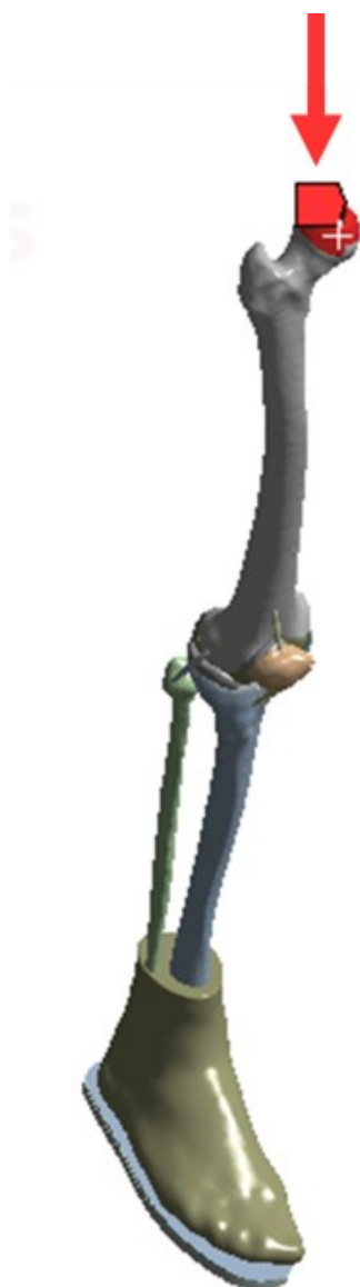
شکل ۵) نمایی از نحوه بارگذاری در محیط نرم‌افزار انسیس
