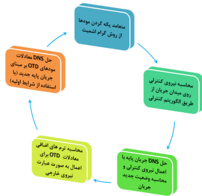
شکل ۳) شماتیک مراحل حل جریان پایه، محاسبه مودهای OTD و نیروی کنترلی در یک گام زمانی
