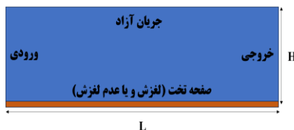
شکل ۲) طرحواره دامنه محاسباتی جریان روی صفحه تخت
